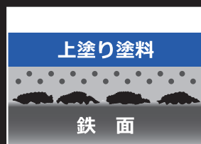
⑤特殊顔料により水性・油性どちらの塗料でも上塗りが可能です。サビを根こそぎ封じ込めた上に、お好みの塗料で仕上げる事が可能です。
