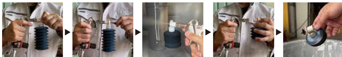
ガンにカートリッジ塗料をカチッと装着。 ノズル前のピンを抜いて準備完了。 トリガーを引くだけ。即、スプレー塗装が可能! 終了後はカートリッジ外す。塗料が残ればピンを戻し保管。 ご使用後は捨てるだけ。ガンの清掃・洗浄一切不要!
